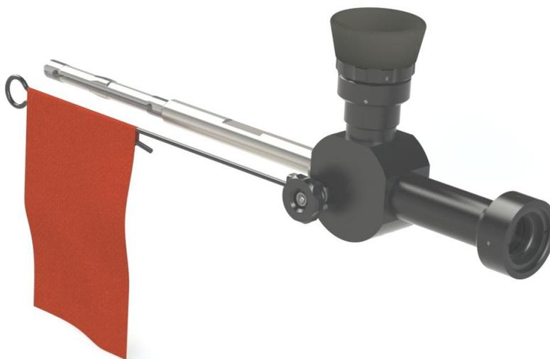
Коллиматор состоит из следующих основных узлов: корпуса, объектива, окуляра с диоптрийным кольцом, хвостовика с пружиной, зажимного винта и флажка.
